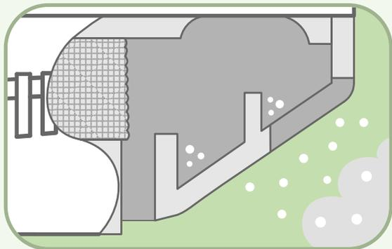
Аэродинамика корпуса обеспечивает **высокую чувствительность к дыму.** Чувствительный элемент располагается **в области максимального скопления дыма**
